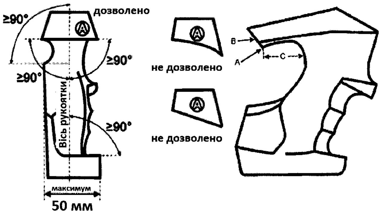
від точки, де верх рукоятки спочатку торкається верху кисті (A) задня (тильна) частина рукоятки має бути зрізана так, щоб вона була під кутом 45 і більше градусів (B). Точка, де верх рукоятки торкається кисті (A), не може виступати назад більше ніж на 30 мм (C) від найглибшої частини рукоятки;
