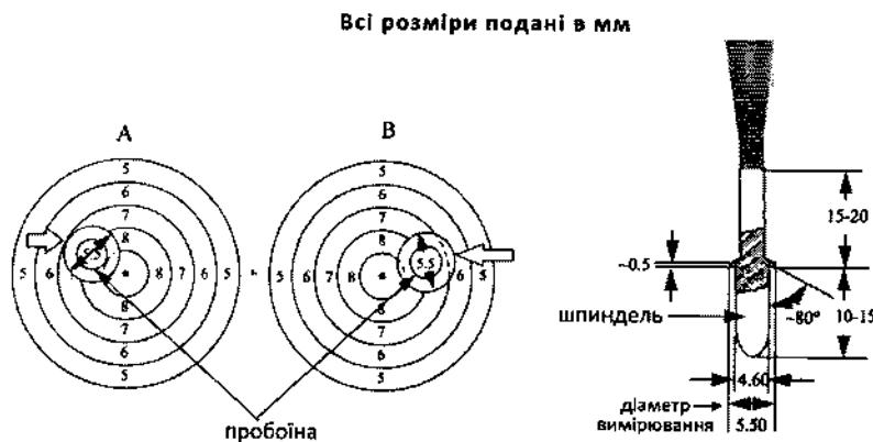
приклад «А» показує сумнівну пробоїну. Зовнішній край фланця зовнішнього вимірювального засобу знаходиться всередині (не виходить за межі) габарита «7», тому вартість такого пострілу – «9»;
