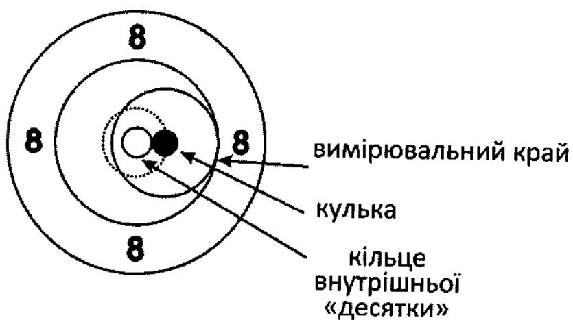
якщо фланець зовнішнього вимірювального засобу визначення внутрішніх «десяток» мішені для пневматичного пістолета не виходить за кільце «9» мішені для пневматичного пістолета, значення пострілу відповідає внутрішній «десятці».
