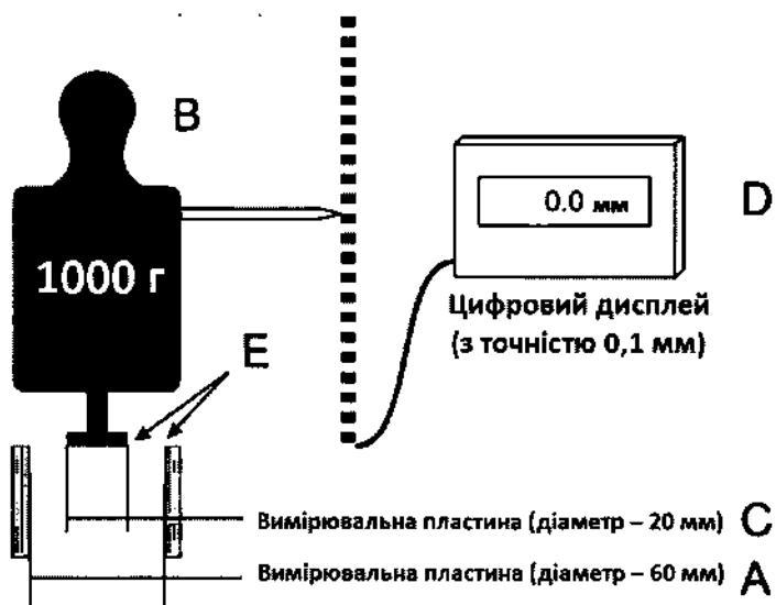
3. Пристрій для вимірювання гнучкості підошви черевиків
