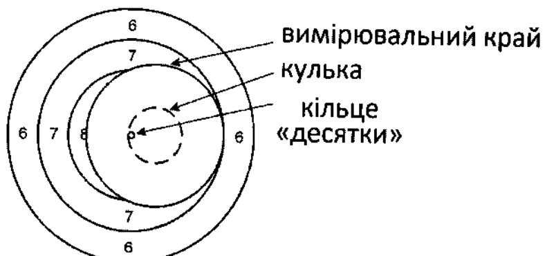
якщо фланець зовнішнього вимірювального засобу для пневматичного пістолета не виходить за кільце «7» мішені для пневматичної гвинтівки, значення пострілу відповідає внутрішній «десятці».
