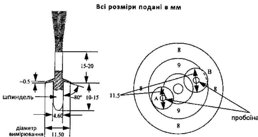
приклад «А» показує сумнівну пробоїну зі вставленим зовнішнім вимірювальним засобом. Зовнішній край фланця цього засобу знаходиться всередині габарита «9», тому вартість пострілу – «10»;
